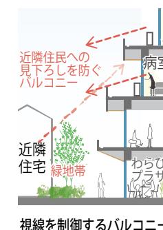
視線を制御するバルコニー
