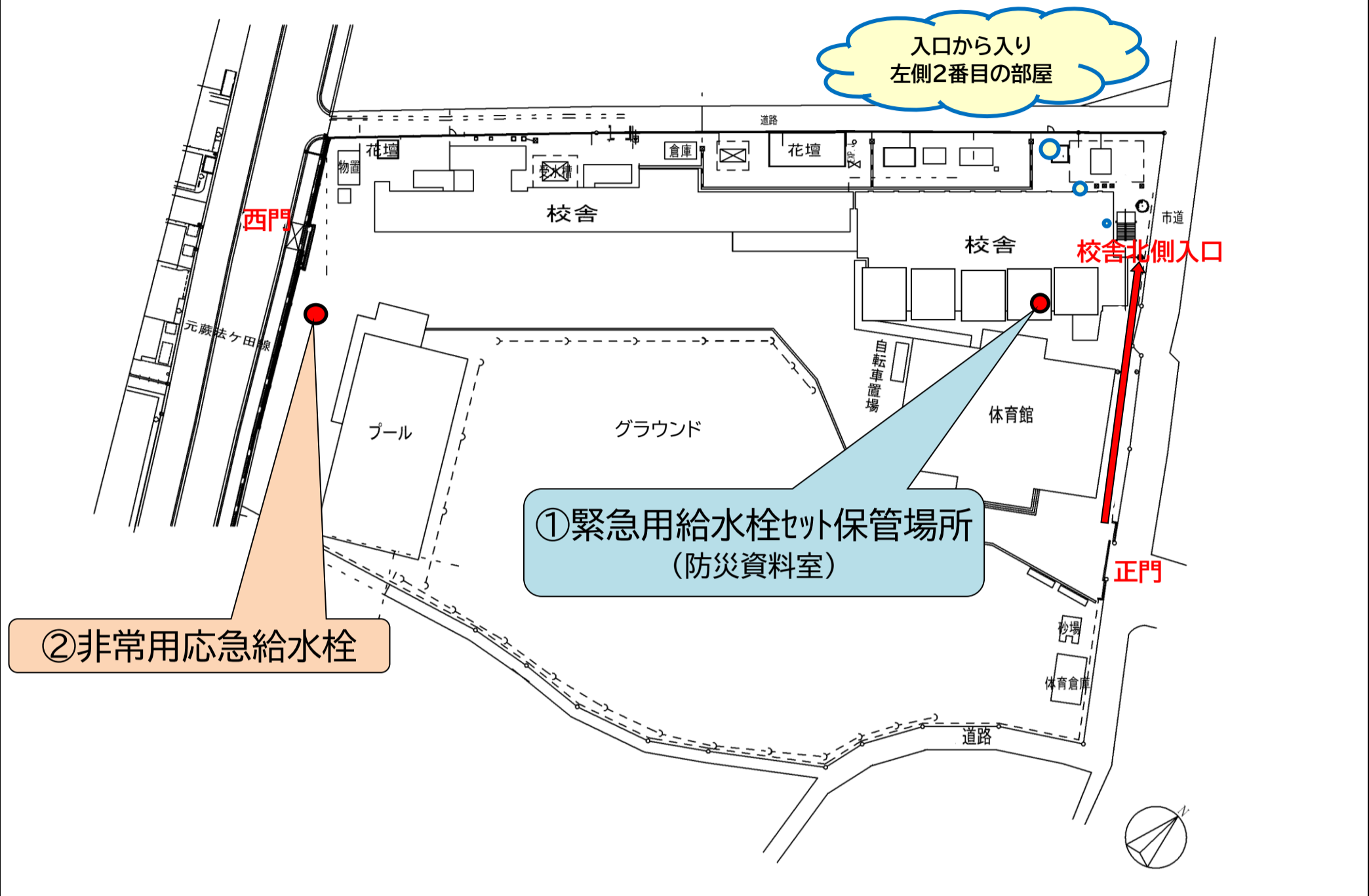
①緊急用給水栓セットの保管場所
