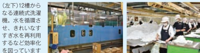
(左下)12槽からなる連続式洗濯機。水を循環させ、きれいなすすぎ水を再利用するなど効率化を図っています
