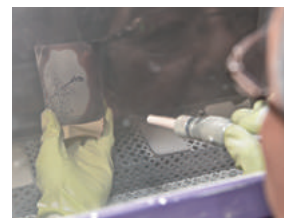
圧縮空気で砂を吹き付けて加工
