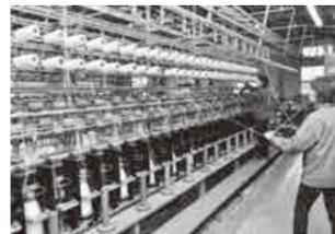
撚糸機で4本の糸を1本に加工。蒸すなどの工程を経て出荷されます
