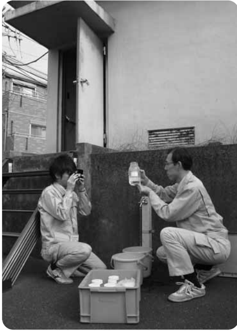
塚越7丁目の7号井戸で水質検査を行う水道部職員
