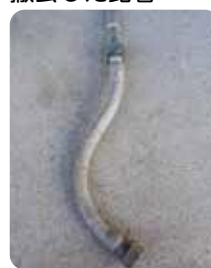
撤去した鉛管
